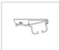
Fixează șina prin clipsare.
